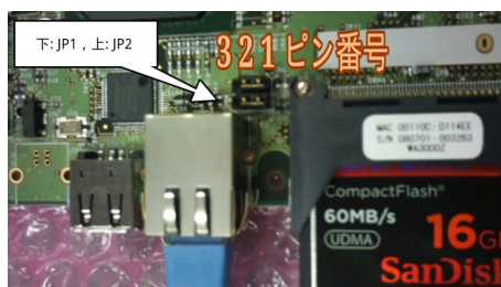
図 2.4: Armadillo300 上のジャンパピンとジャンパピン番号
