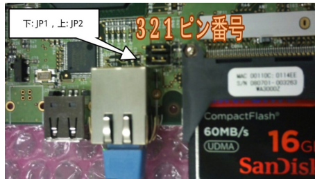
図 2.3: Armadillo300 上のジャンパピンとジャンパピン番号
